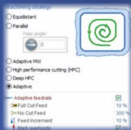
Die Funktion kann über die Auswahl Fastmill Adaptiv aktiviert werden. Wichtig dabei ist auch die Aktivierung der Funktion Adaptiver Vorschub im Vorschubbereich. Durch die Kombination beider Einstellungen wird von der Software ein konstantes Spanvolumen gehalten. Die Parameter für den Vorschub können aus den Voreinstellungen übernommen werden.
